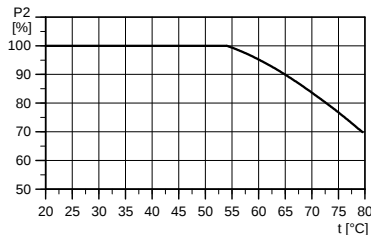
Fig. 14 Reducerea puterii în raport cu temperatura ambiantă
